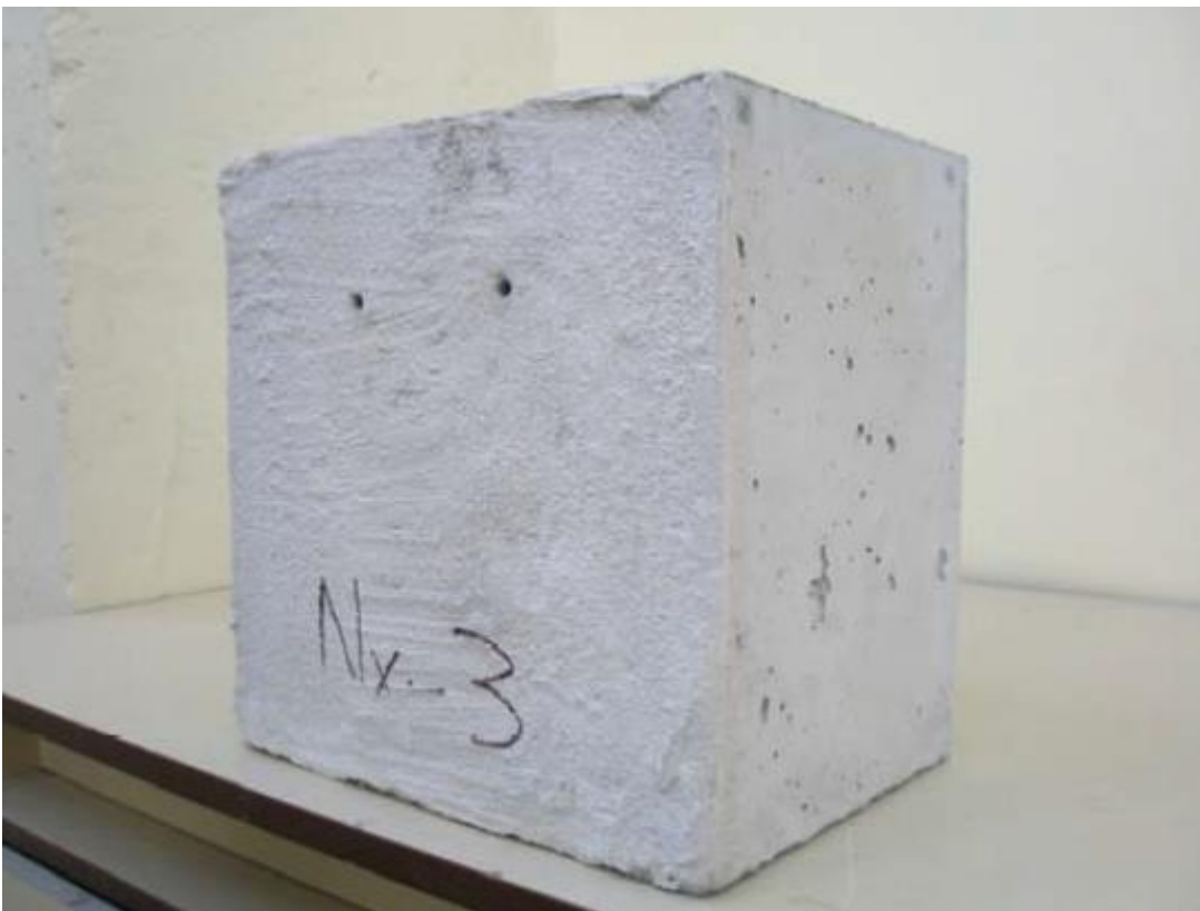
Kuva 1. C20/25 Testikappale jossa Xypex Concentrate sively
