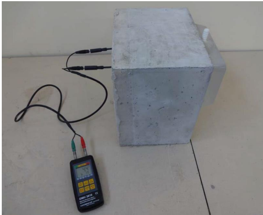
Kuva 4. Kosteuden mittaaminen Xypex Concentrate käsitellystä kappaleesta
