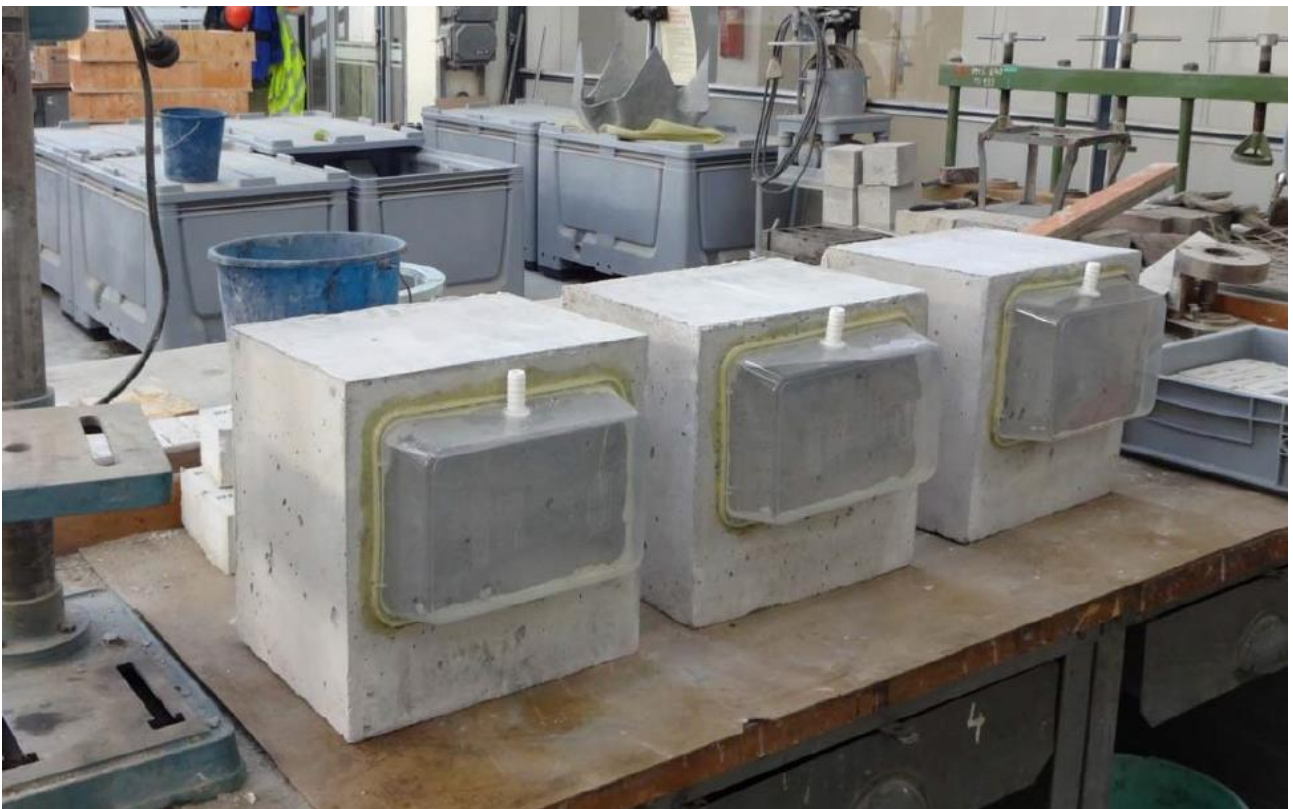
Kuva 2. Vesisäiliöt asennettuna testikappaleiden pintaan.
