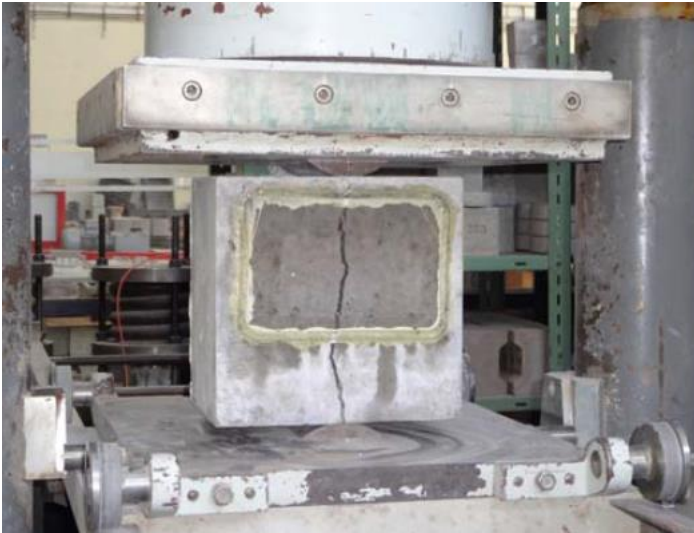
Kuva 5 ja 6. Kappaleet rikottiin hydraulisella puristimella ja niistä otettiin koepalat niistä kohdista, joissa anturit olivat sijainneet. Koepalat punnittiin ja kuivattiin uunissa. Kuivatut palat punnittiin uudelleen kappaleiden todellisen kosteussisällön toteamiseksi.
